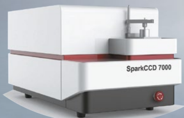
Искровой оптико-эмиссионный спектрометр «SparkCCD 7000»
