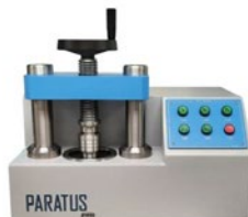
Полуавтоматический пресс с усилием до 40 тонн
