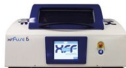
Печи для сплавления проб с флюсом на 1, 2 и 6 позиций
